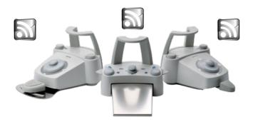
Fußschalter. Es stehen drei Ergonomien zur Verfügung, die alle ebenfalls in drahtloser Ausführung erhältlich sind. Sie ermöglichen die Chip-Air/Water-Aktivierung, die Umschaltung der Drehrichtung des Mikromotors, die Bewegung des Behandlungsstuhls und das Aufrufen der abgespeicherten Positionen.
